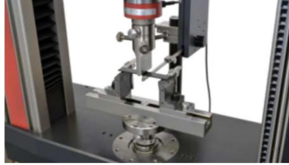
Çekme-Basma-3 Noktadan Eğme Test Cihazı
