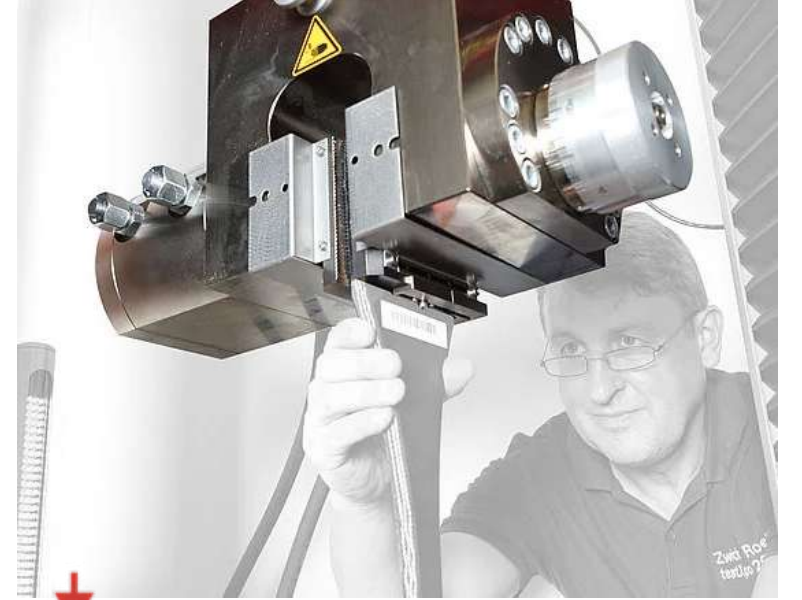
Çekme-Basma-3 Noktadan Eğme Test Cihazı
