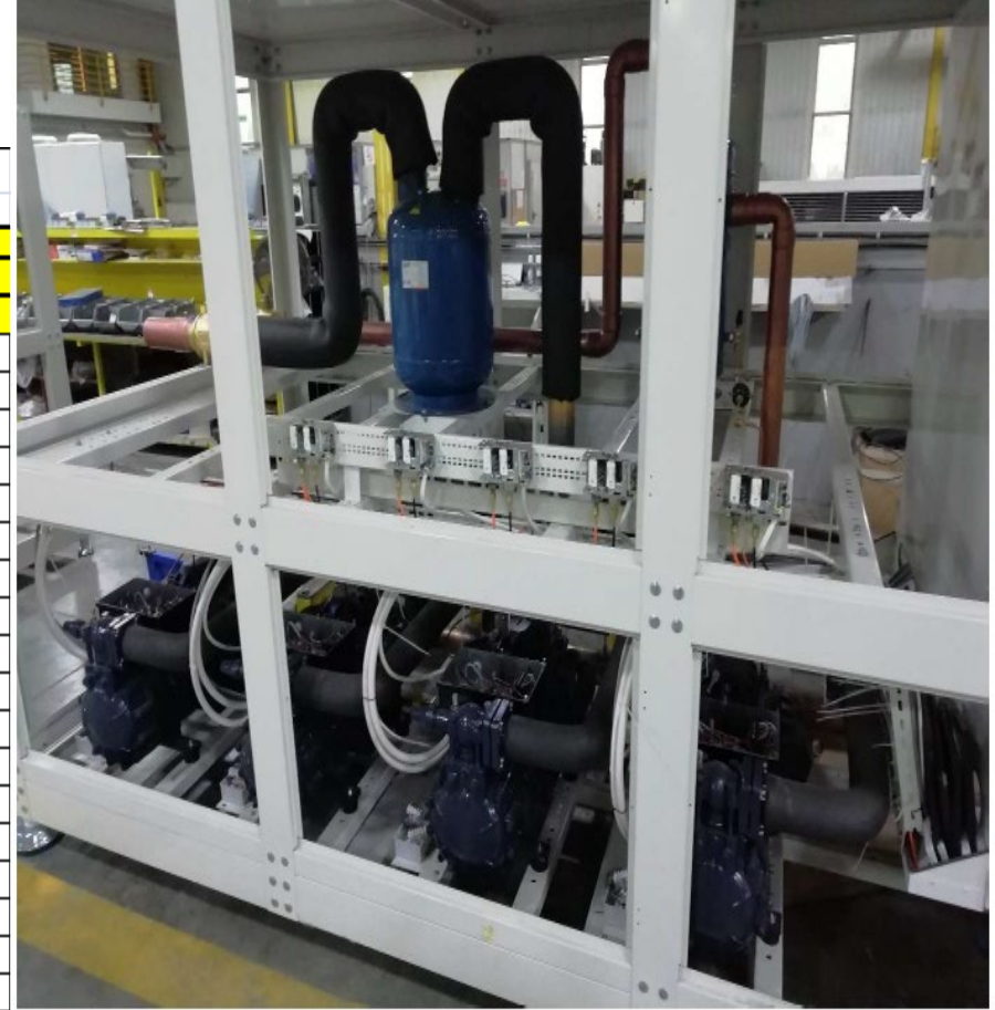
Şekil 1. Merkezi Soğutma Sistemi
