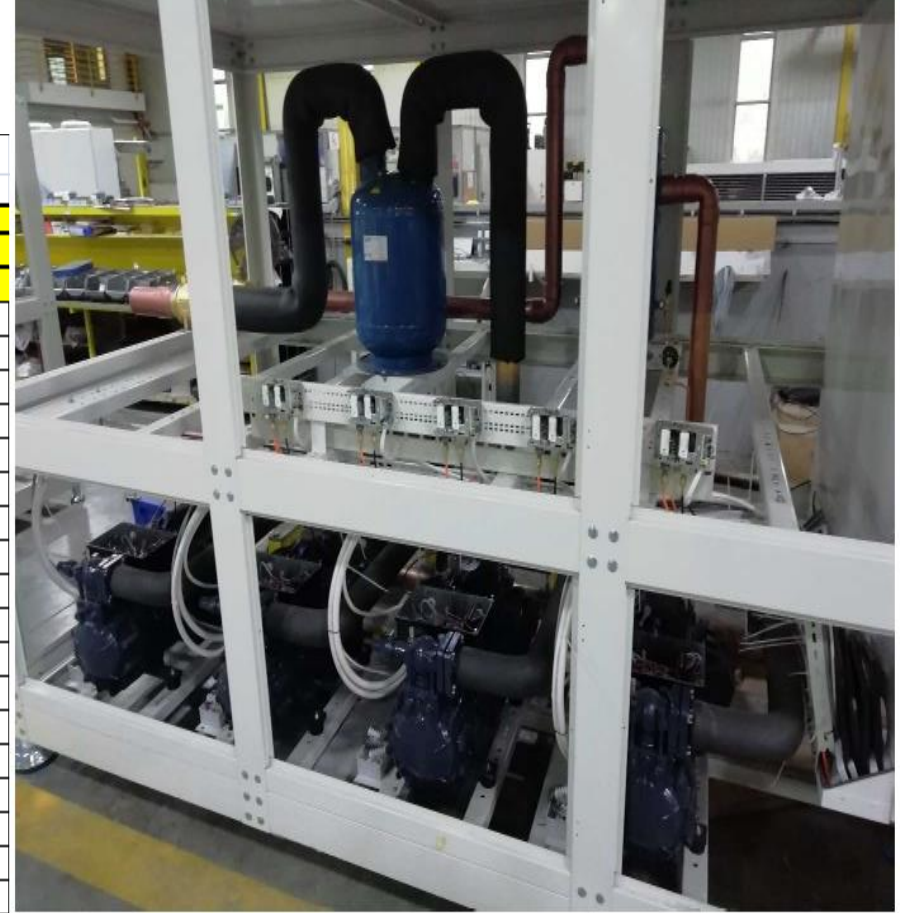
Şekil 1. Merkezi Soğutma Sistemi
