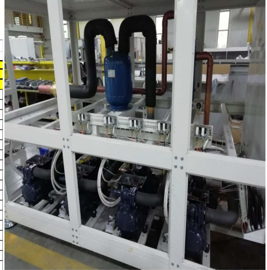
Şekil 1. Merkezi Soğutma Sistemi
