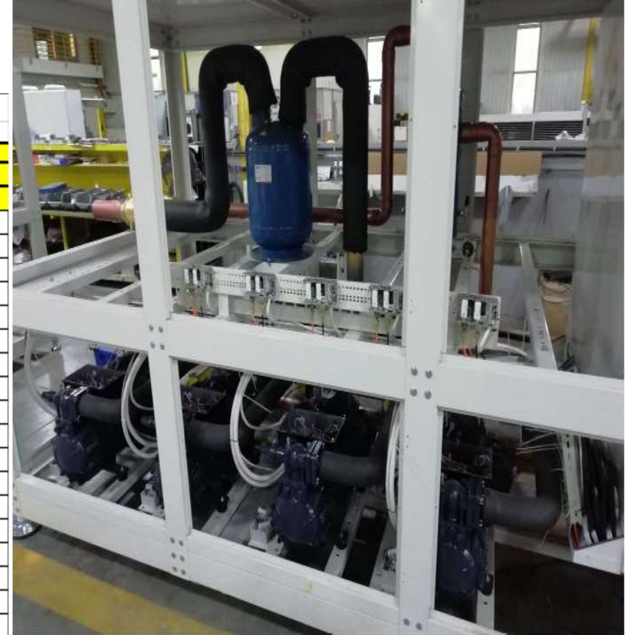
Şekil 1. Merkezi Soğutma Sistemi
