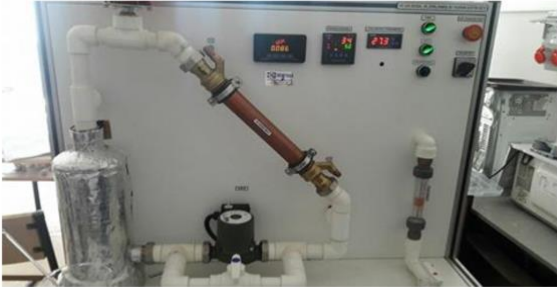
Őekil 1. Doėal ve zorlanmış ısı taŐınımı deney dzenegi
