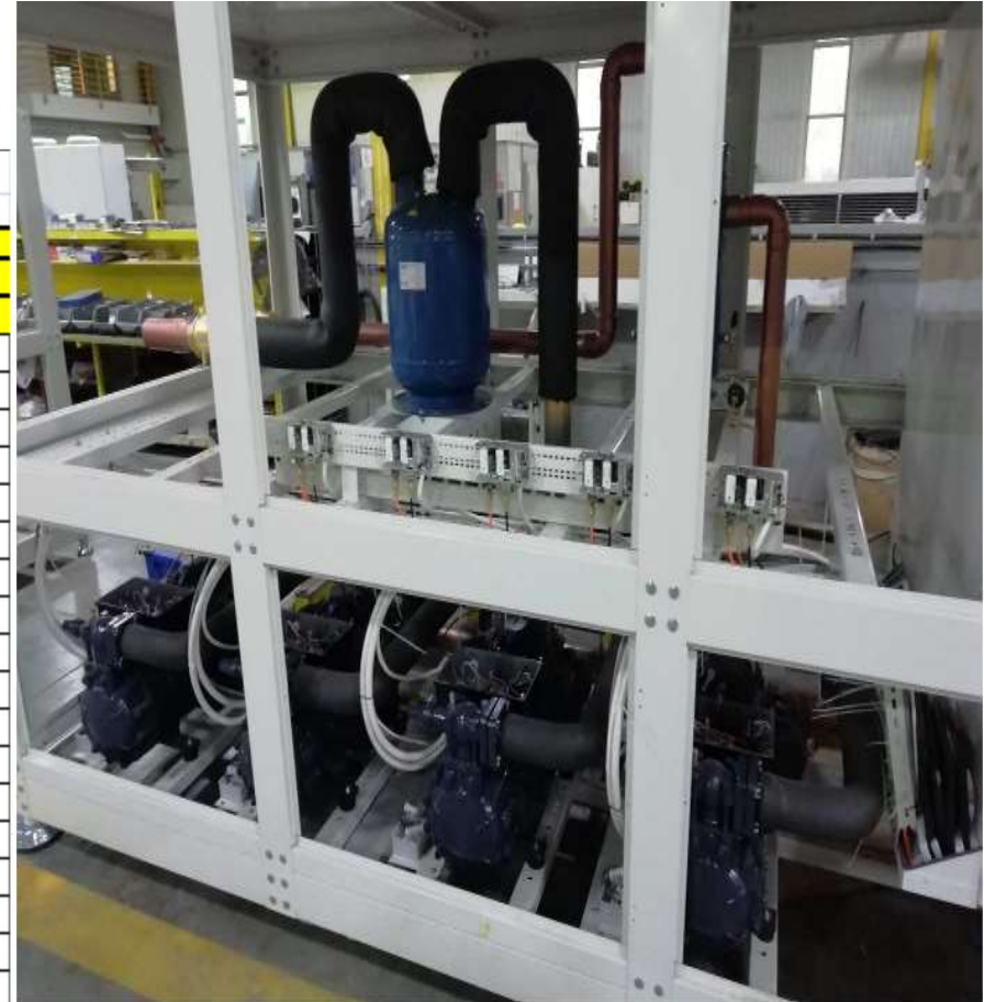
Şekil 1. Merkezi Soğutma Sistemi
