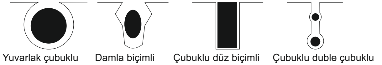
Şekil- 15.3 : Rotor çubuk biçimi ve kesiti
